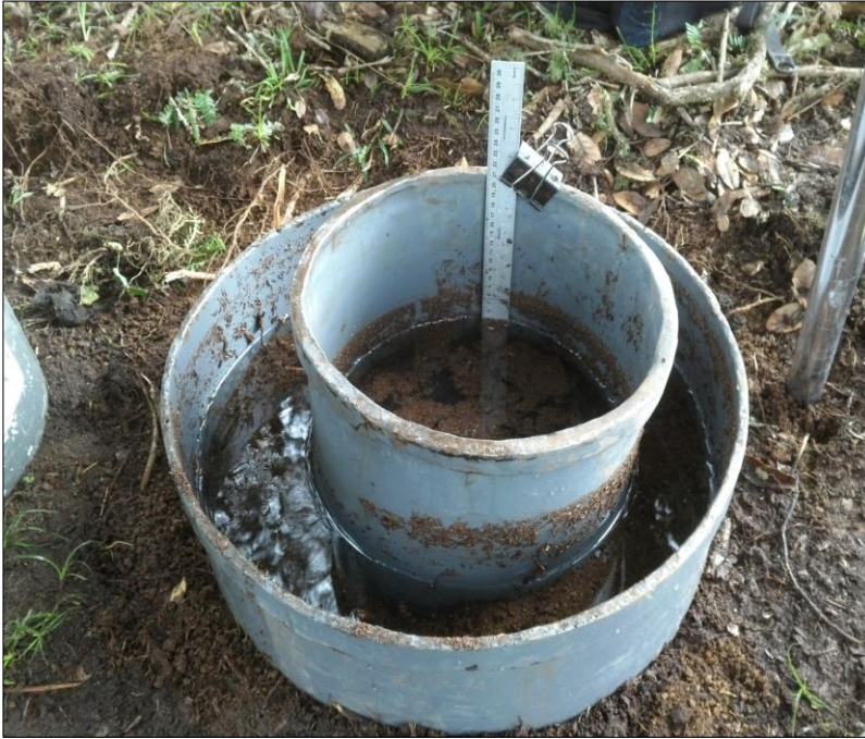
Fotografía 10: Prueba de infiltración
