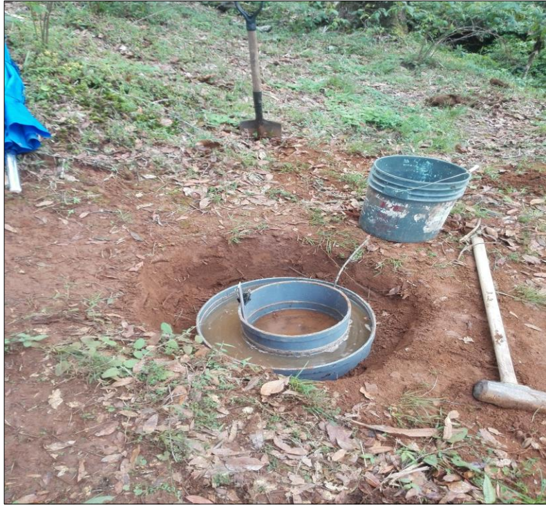
Fotografía 11: Prueba de infiltración
