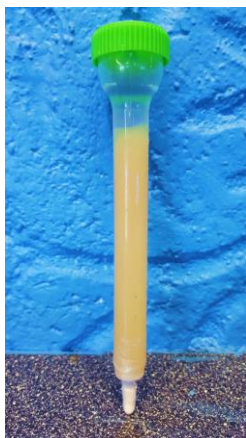
Figura 22. Columna de CIA empleada para la separación del arsenito y el arseniato.
