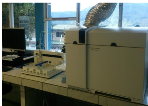
Figura 21. Espectrómetro de masas con plasma de acoplamiento inductivo Agilent serie 7700 ubicado en la sección de química de agua potable del LNA.
