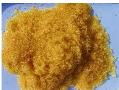
Figura 12. Resina Dowex 1-X8 de 50 a 100 mallas.
