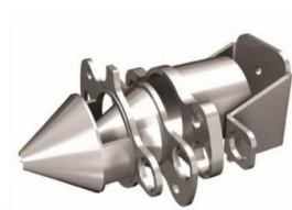
Figura 17. Lentes iónicas de espectrómetro de masas con plasma de acoplamiento inductivo. Imagen tomada de (Rodríguez, 2012b).
