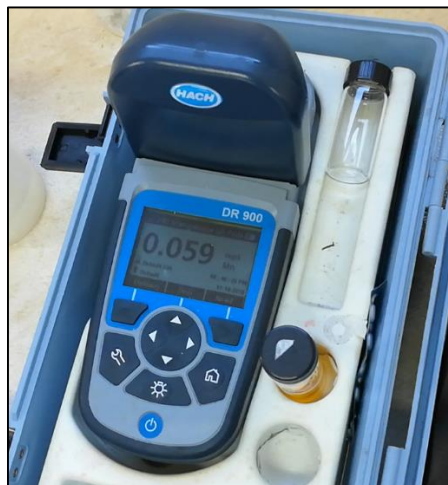
Figura 17 Determinaciones de Mn en agua tratada con equipo DR900
