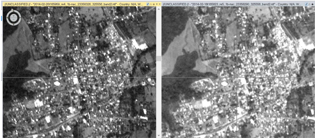
Figura 6. Dos imágenes nivel básico vinculadas. Se puede ver una cruz en cada ventana. Está localizada en el mismo lugar de la imagen de la izquierda. Como se puede ver hay una diferencia en la localización.
