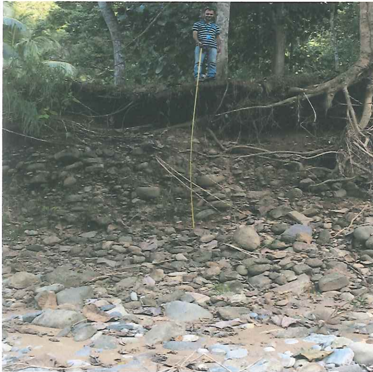
Fotografía 3: Corte de aluvión donde se observa su espesor mínimo, identificado en las coordenadas 359,383 Norte y 479,214 Este, proyección Lambert Costa Rica Sur.
