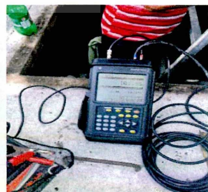
Medición de caudales con equipo ultrasónico inicio de tubería de conducción Naciente La Habana
