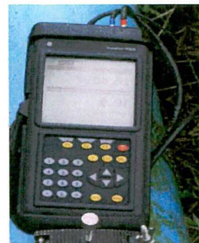
Medición de caudales con equipo ultrasónico inicio de tubería de conducción Naciente Platanillos
