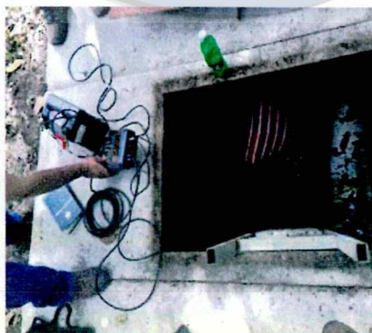
Medición de caudales con equipo ultrasónico inicio de tubería de conducción Naciente La Habana
