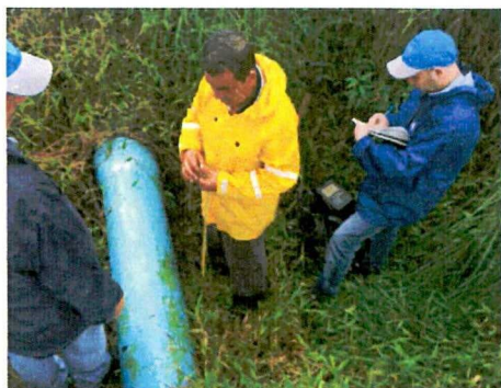
Medición de caudales con equipo ultrasónico inicio de tubería de conducción Naciente Platanillos
