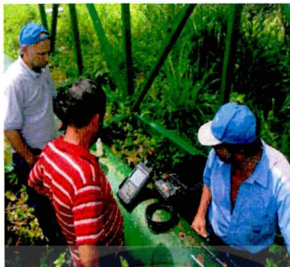
Medición de caudales con equipo ultrasónico paso elevado Río Arenal tubería de conducción Naciente La Habana
