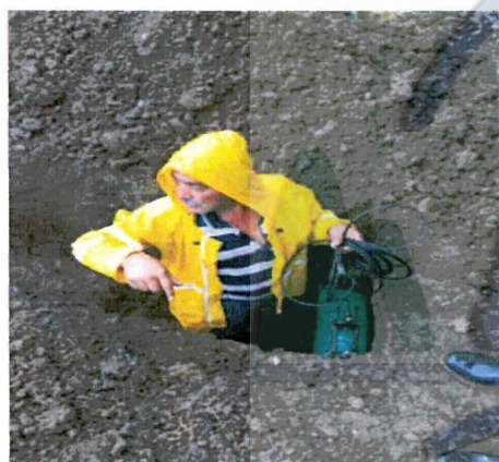
Medición de caudales con equipo ultrasónico entrada a Tanque Alto Cedros
