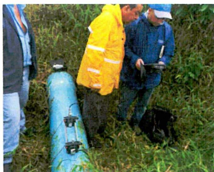
Medición de caudales con equipo ultrasónico inicio de tubería de conducción Naciente Platanillos
