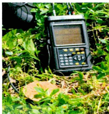
Medición de caudales con equipo ultrasónico paso elevado Río Arenal tubería de conducción Naciente La Habana
