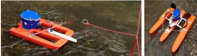
Figura N° 6 Aforadores Acústicos por Efecto Doppler (ADCP) del AyA
