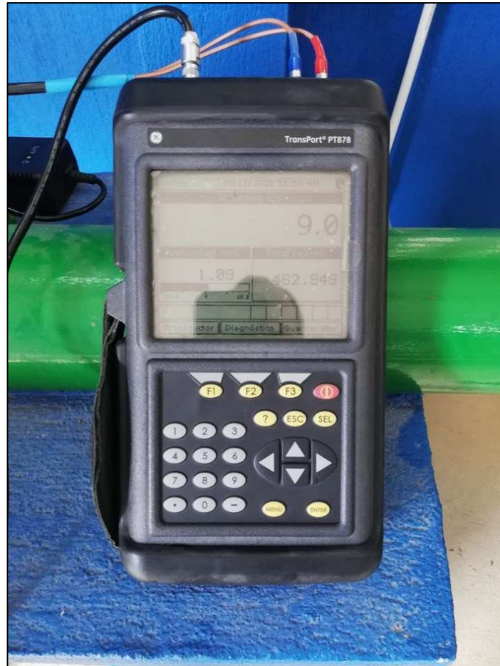
Figura 3. Medición de caudal en sitio.
