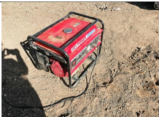
Figura 15. Maquinaria sin contenedor en caso de derrame.
