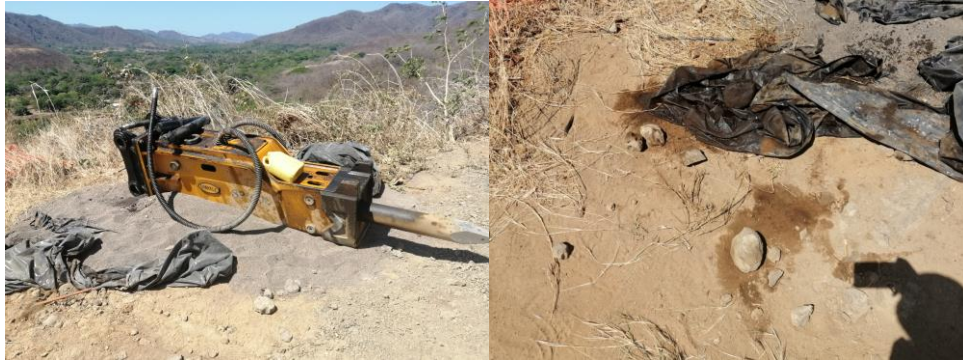
Figura 35. Derrame de aceite hidráulico.
