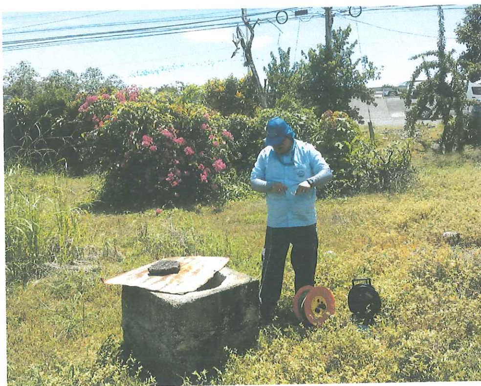
Fotografía 9: Medición de nivel estático en pozo artesanal ubicado en las coordenadas Lambert Norte 160229 N y 516973 E.
