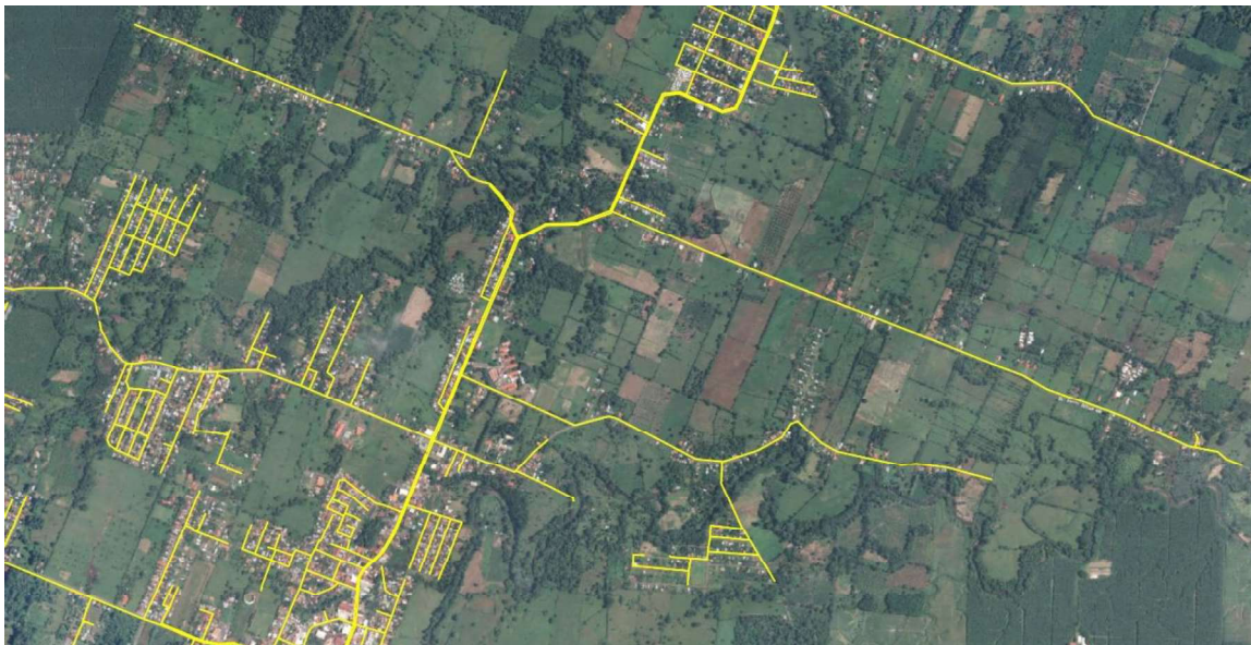
Figura 1: Ubicación parcial de las líneas de distribución del acueducto de Cariari-Anita Grande.
