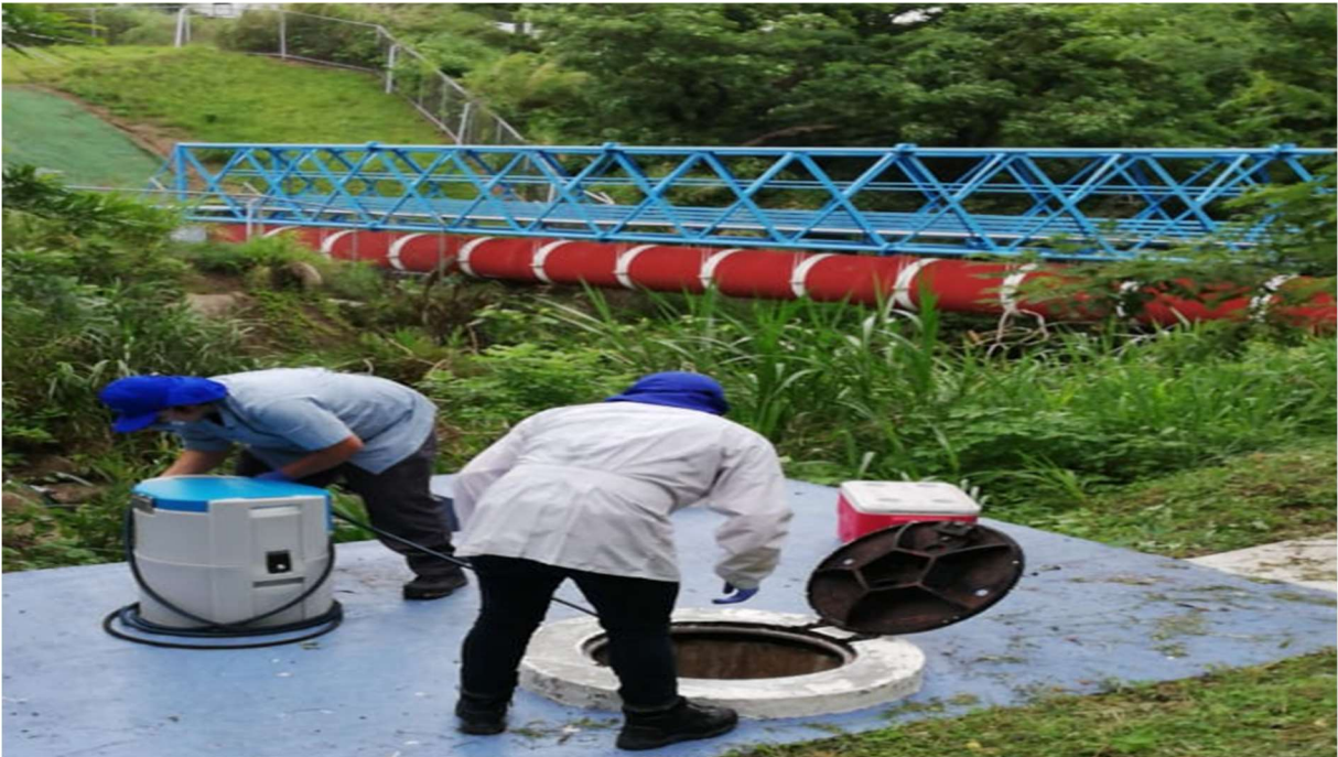
Muestreo realizado en colectores de aguas residuales de la GAM. Fuente: Laboratorio Nacional de Aguas, Junio, 2020.
