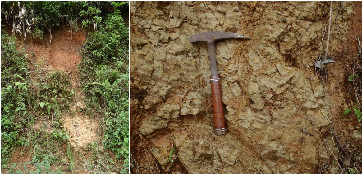
Fotografía 2. Rocas de la Formación Peña Negra en 516940E-202986N. Roca meteorizada a colores crema sobreyacida por suelos residuales y coluvios (izq.), y un detalle de roca meteorizada buzando 38° al azimut 3°.
