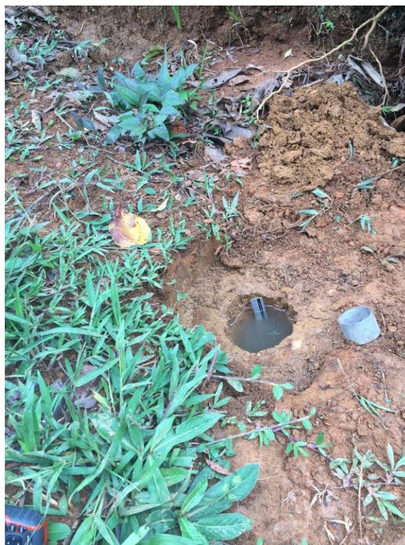
Fotografía 4: Prueba de infiltración 3 coordenadas 569867 – 134670 Lambert.
