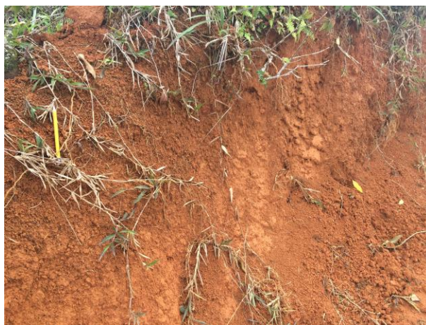
Fotografía 3: Arcillas con espesor aproximado de 2 m, producto de la fuerte meteorización coordenadas 569 912 - 134 898 Lambert
