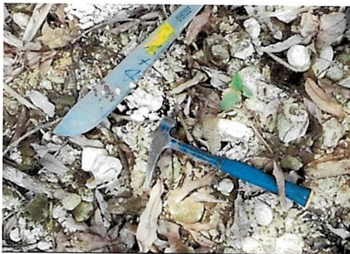
Fotografía N°1. Fragmentos de rocas sedimentarias localizados sobre la superficie del terreno específicamente en el sector este. Se interpreta que los mismos están in situ evidenciando los primeros metros de meteorización y alteración de esta unidad.
