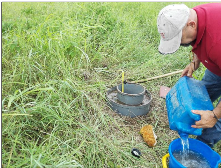
Fotografía 11: Prueba de infiltración P1, coordenadas 261169 N y 350377 E.
