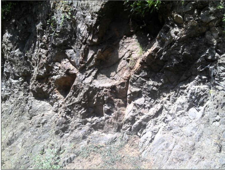
Fotografía 7: Afloramiento de basaltos fracturados y cizallados, coordenadas 260393 N y 349459 E.
