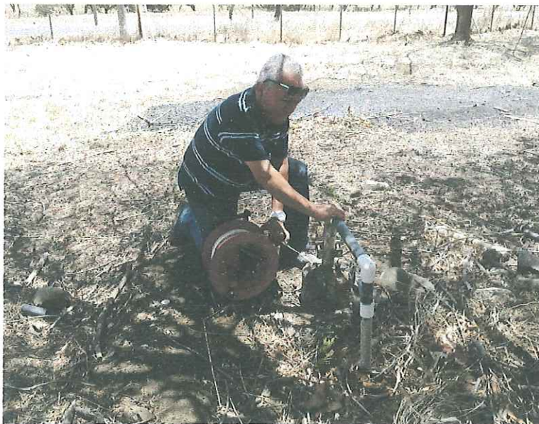
Fotografía 10: Medición de nivel de agua en pozos perforado (Pozo 6), coordenadas 414543 E/267267 N.
