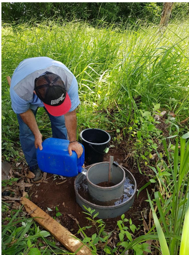
Fotografía 3: Prueba de infiltración por método de doble anillo, coordenadas:209352 N/ 472126 E
