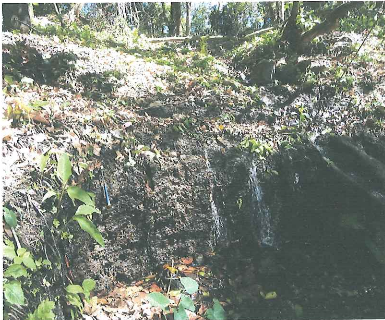
Fotografía 2: Flujos de agua subterránea aflorando en el contacto entre las rocas del Miembro Bermúdez y la formación Tiribí
