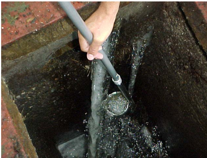
Se muestra el método utilizado para recoger la muestra de agua residual tratada (1 er muestreo)
