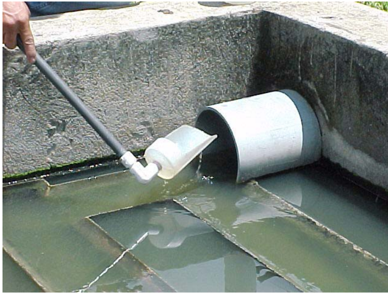
Sitio de muestreo del agua residual tratada en canaleta de recolección del sedimentador secundario (2 do muestreo)
