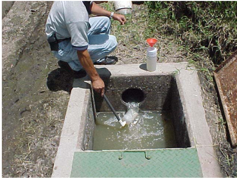
Sitio de muestreo del agua residual cruda (afluente) en trampa de grasa y sólidos (luego de la cámara de rejillas) (2 do muestreo)
