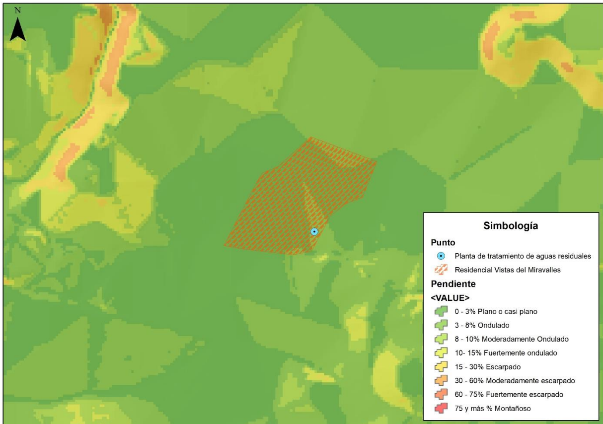
Figura 2. Pendiente del terreno donde se ubica la PTAR.
