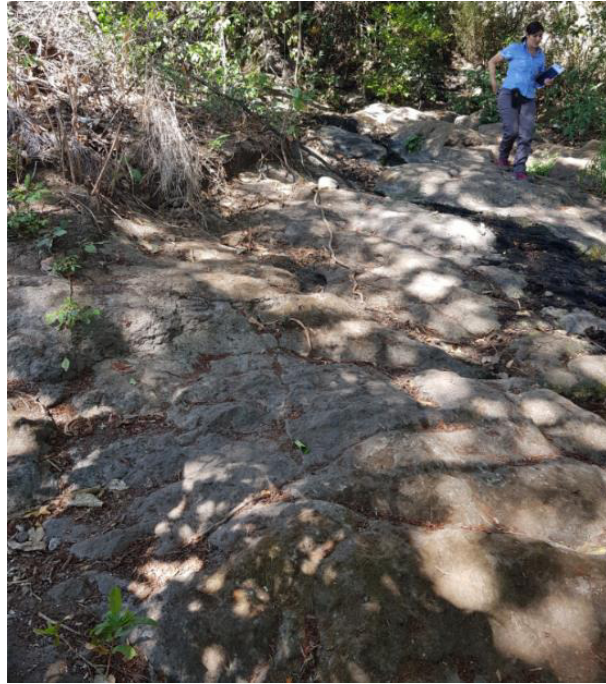
Fotografía N° 6 Ignimbrita masiva de buena calidad geomecánica aflorando en el segundo cauce las coordenadas lambert norte 212176/519944.
