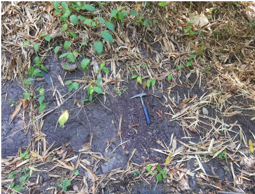
Fotografía N° 1 Afloramiento de areniscas vulcaniclásticas en quebrada intersecada por tubería en tramo 15+500-16+000 correlacionado con la formación Pacacua. (Coordenadas Lambert Norte 209759/510183)
