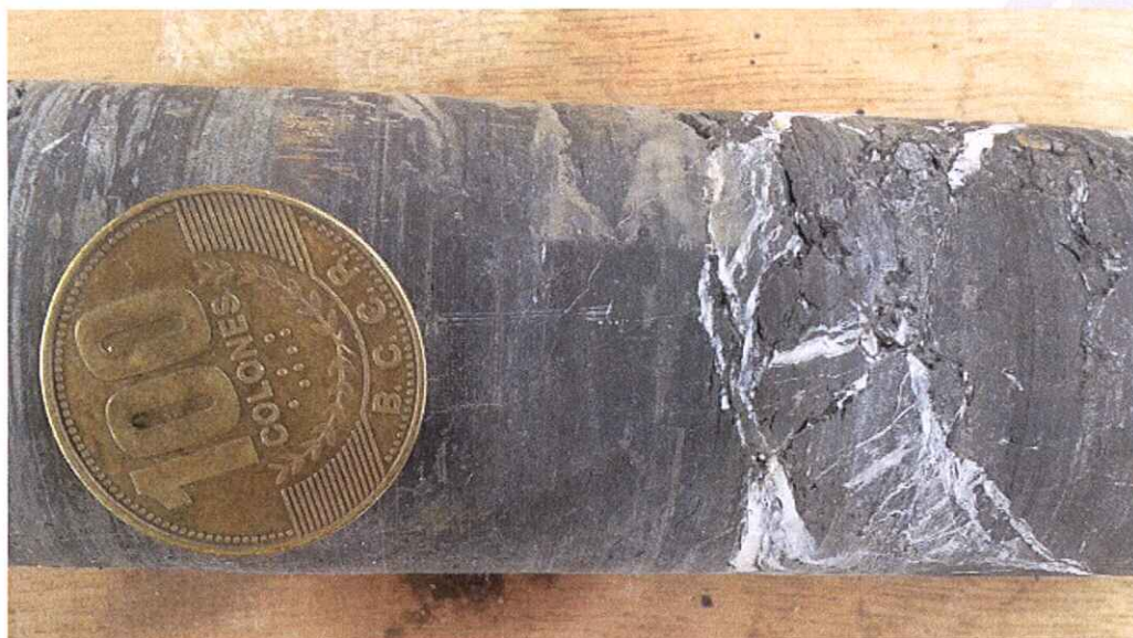
Foto N°2. Núcleo de perforación tramo 48,70 m – 49,50 m (Lutita con vetas de calcita).
