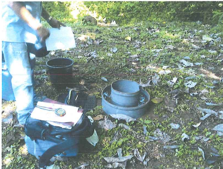
Fotografía 4: Prueba de infiltración 1, coordenadas 279420 N y 590103 E.
