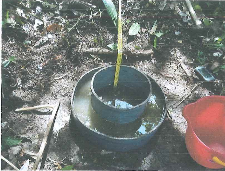
Fotografía 5: Prueba de infiltración 2, coordenadas 279350 N y 589983 E.
