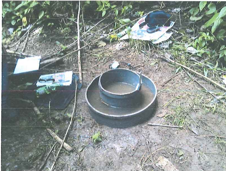
Fotografía 6: Prueba de infiltración 3, coordenadas 279410 N y 590,049 E.
