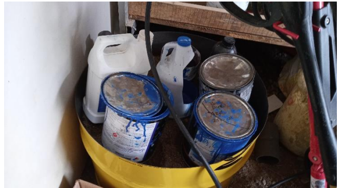
Sistema para contención de pinturas y diluyentes en uso.
