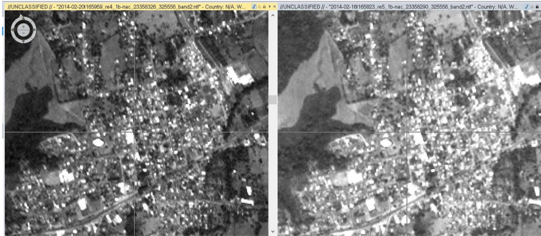
Figura 6. Dos imágenes nivel básico vinculadas. Se puede ver una cruz en cada ventana. Está localizada en el mismo lugar de la imagen de la izquierda. Como se puede ver hay una diferencia en la localización.
