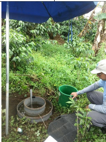
Fotografía 9: Prueba de infiltración 3 (Inf-3), coordenadas 508765 E/226727 N
