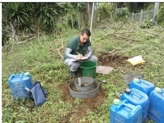
Fotografía 8 Prueba de infiltración 2 (Inf-2), coordenadas 508896 E/ 226677 N
