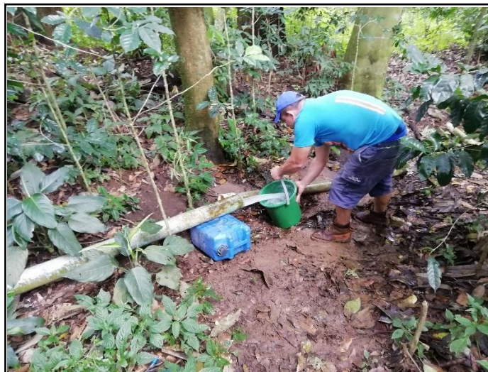
Fotografía 6: Medición de caudal naciente Rufino, coordenadas 508958 E / 226663 N.
