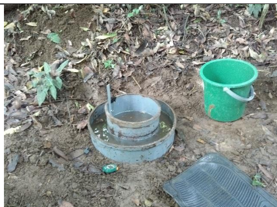
Fotografía 7: Prueba de infiltración 1 (Inf-1), realizada en la naciente Rufino, coordenadas 508959 E/226662 N
