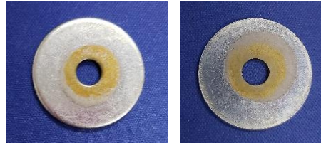
Ilustración 3: Placa de orificio 5.70 mm después del desgaste acelerado. Fuente: propia (marzo 2020).
