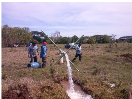
Desarrollo de la prueba de bombeo en el pozo 04-03.
