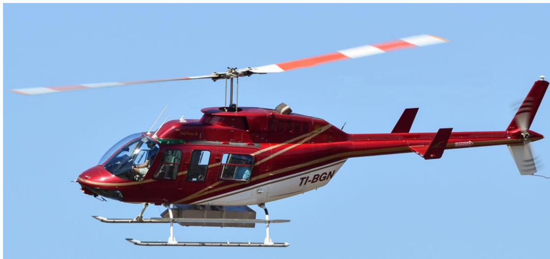
Figura 4. Helicóptero Bell 206 TI-BGN empleado para la captura de imágenes y LiDAR aéreo, equipado con el sistema de captura combinada imagen fotogramétrica y LiDAR.
