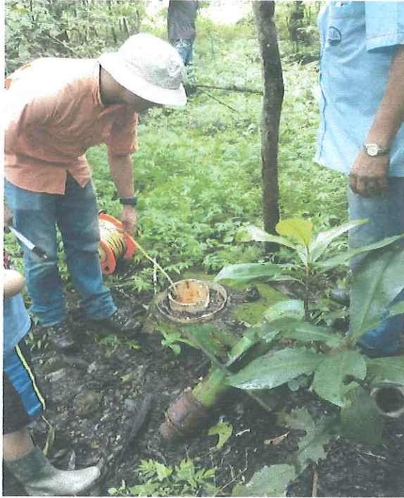
Fotografía 18: Pozo 10, Finca La Ecológica, coordenadas 435648 E/244657 N, nivel estático medido en 3,57 m.b.n.s.
