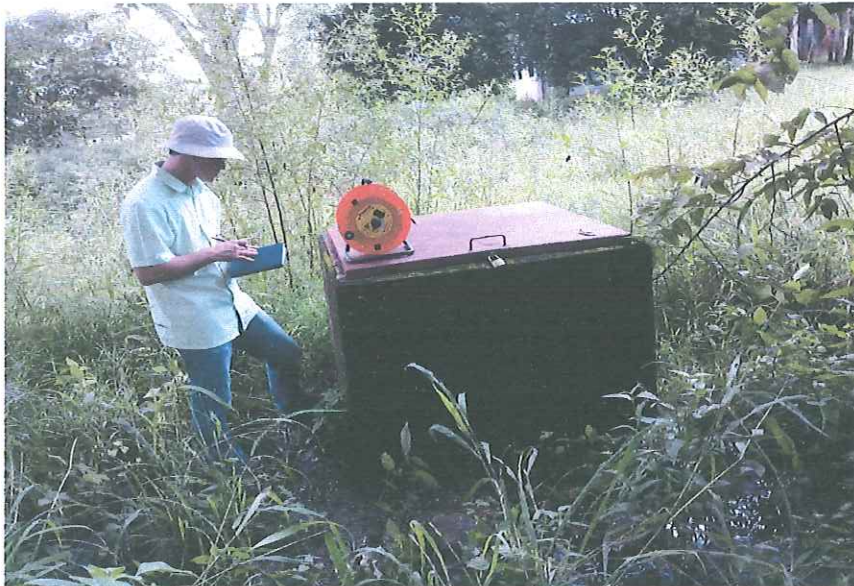
Fotografía 13: Pozo 4, Coordenadas 434870 E/239606N, nivel estático medido en 5,09 m.b.n.s.
