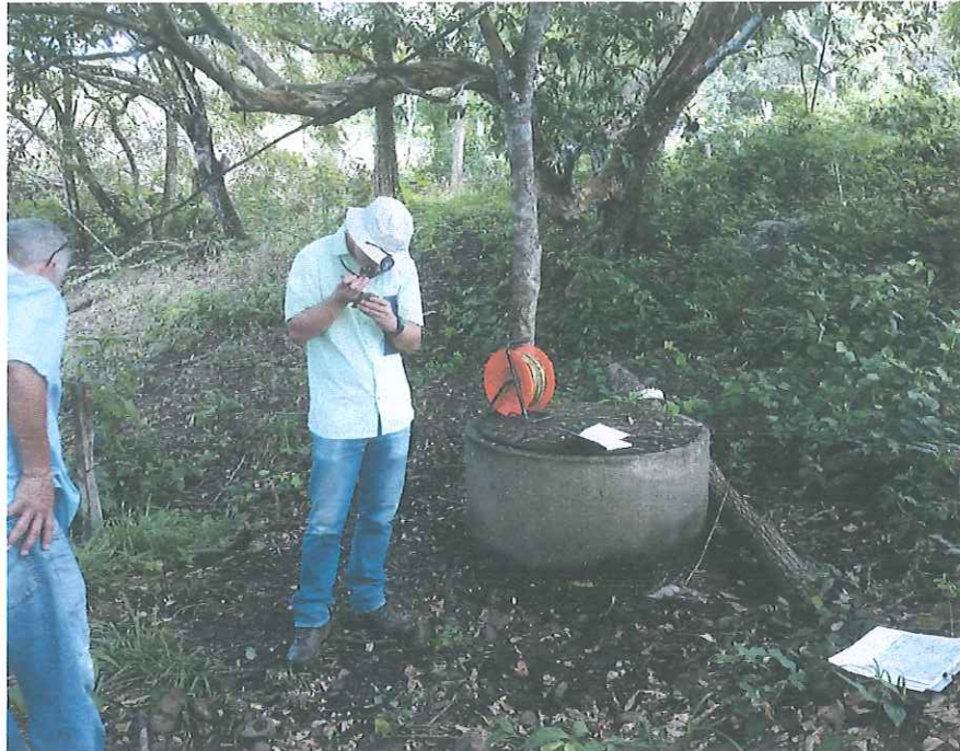
Fotografía 12: Pozo 3, coordenadas 434305 E/239906 N, nivel estático medido en 1,07 m.b.n.s
