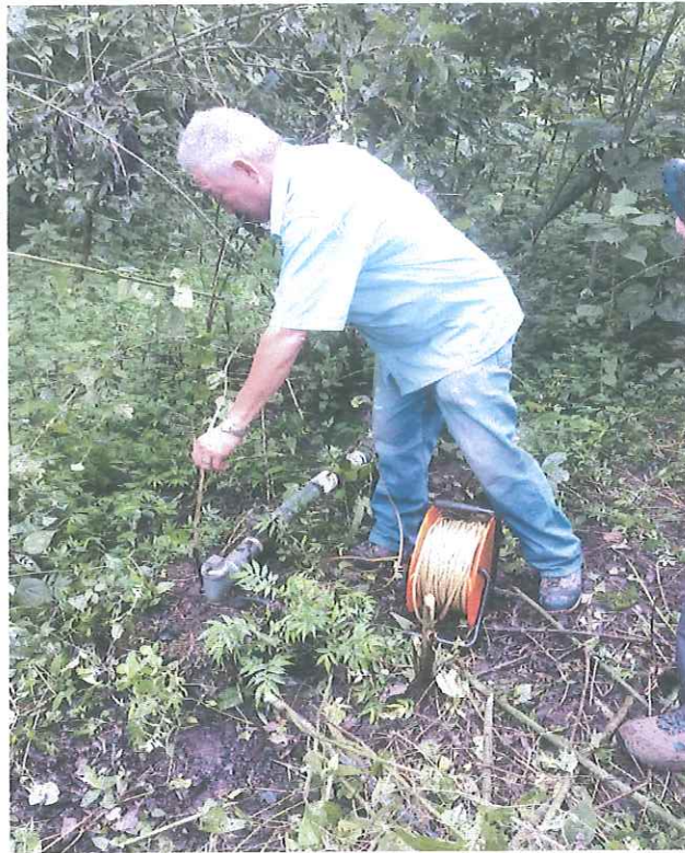
Fotografía 20: Pozo 12 Finca La Eológica, coordenadas 244600 E/436100 N, nivel estático medido en 1,35 m.b.n.s.
