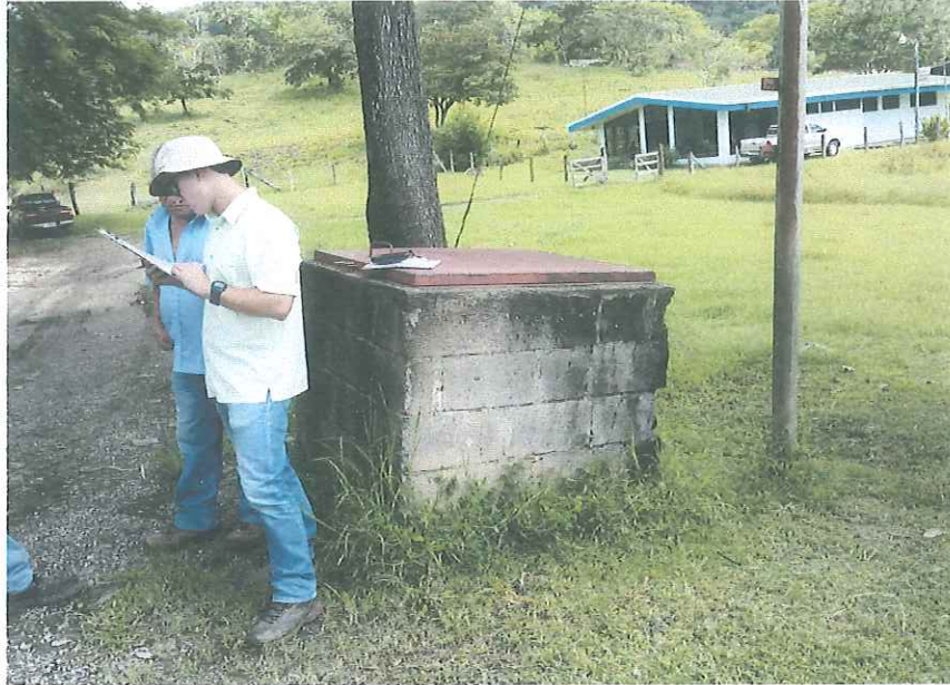
Fotografía 10 : Pozo 1 ASADA Guaitilar, coordenadas 433537 E/240762N, nivel estático medido en 23,89 m.b.n.s.
