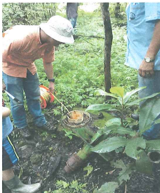
Fotografía 9: Medición de nivel de agua en pozo perforado en la finca La Ecológica, coordenadas 244323 N y 436210 E.
