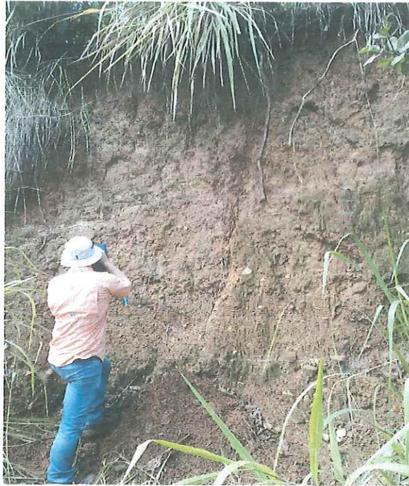
Fotografía 6: : Afloramiento de depósito coluvio-aluvial en las coordenadas 238592 N y 434110 E. Nótese hacia la parte inferior del depósito una textura más blocosa para el mismo, mientras que hacia la parte superior el depósito tiende a ser con una textura uniforme.
