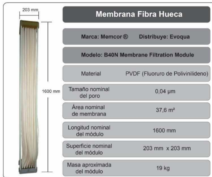
Figura 34. Especificaciones del módulo de membrana seleccionado Fuente: Adaptado de Evoqua, 2015.
