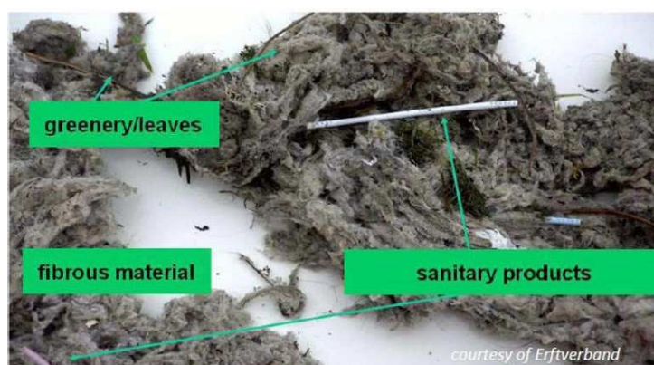
Figura 20. Diferentes tipos de residuos recolectados de un alcantarillado sanitario. Fuente: Yoon, 2011.
