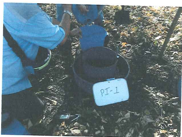
Foto 18: Prueba de infiltración PI-1
