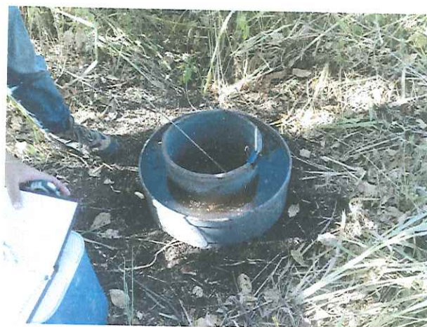
Foto 20: Prueba de infiltración PI-3
