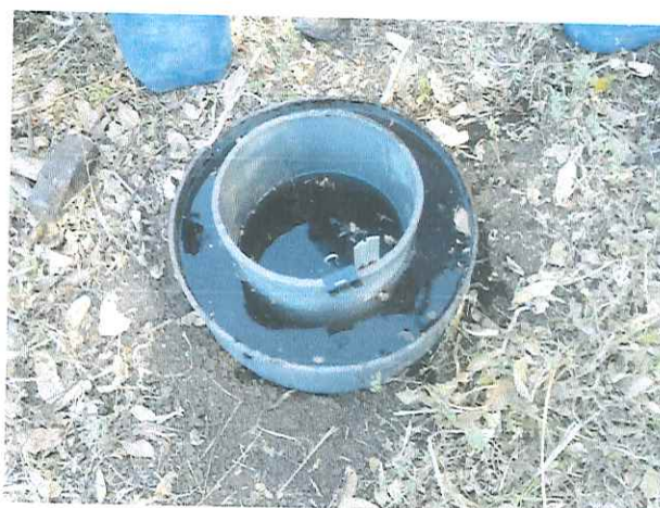
Foto 19: Prueba de infiltración PI-2
