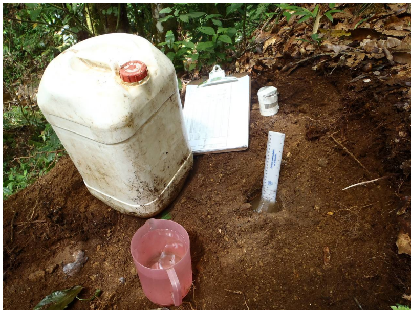
Fotografía 7. Medición de permeabilidad en margen izquierda del sitio de toma, punto 1.
