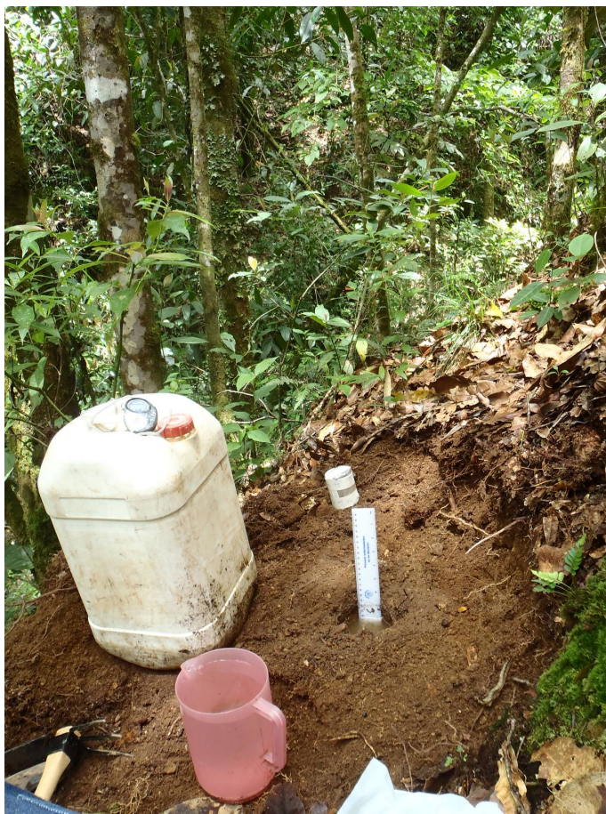
Fotografía 8. Medición de permeabilidad en margen izquierda del sitio de toma, punto 1.
