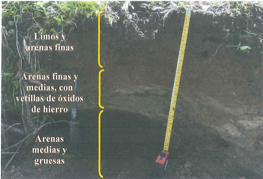
Fotografía 2: Vista del perfil más somero de suelo en la plaza de deportes de Caño Seco. (276,282 Norte y 557,462 Este, proyección Lambert Costa Rica Norte)
