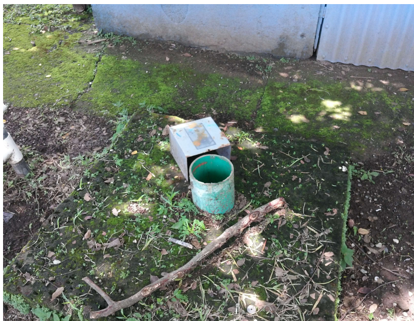
Foto 3. Piezómetro. Coordenadas: 355592 E/218260 N
