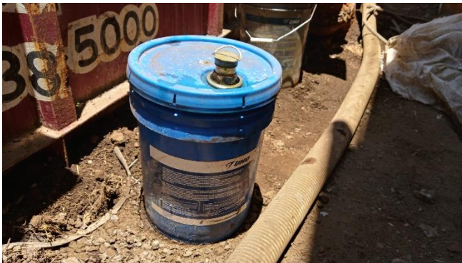
Almacenamiento de lubricantes sin sistema para contención de derrames.
