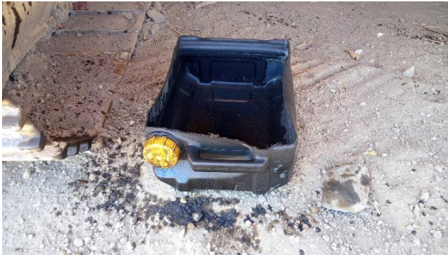
Bandeja de tamaño insuficiente para recolectar los derrames por goteo.
