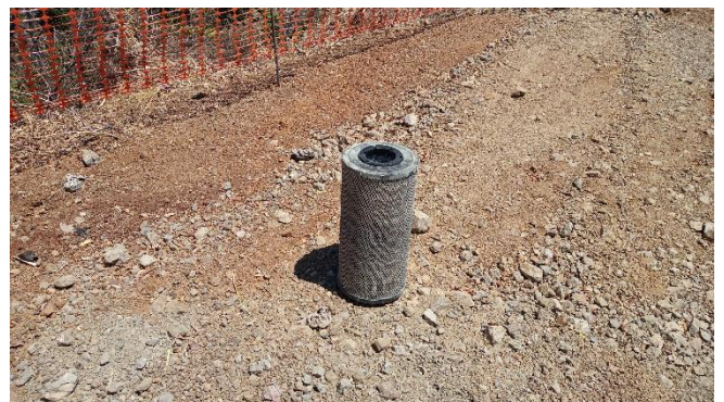
Filtro producto del mantenimiento preventivo de la maquinaria, inadecuadamente dispuesto.
