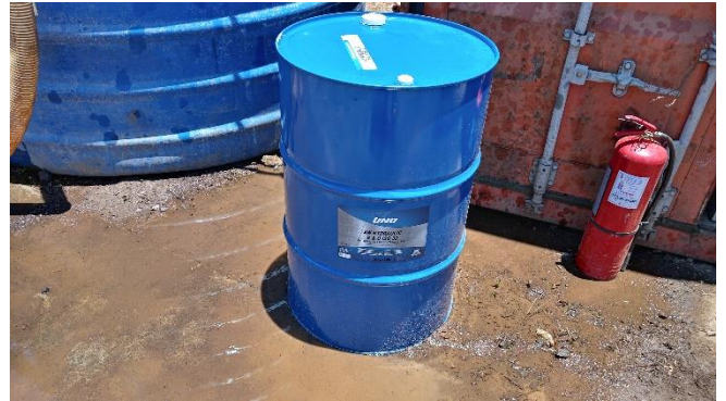
Almacenamiento de lubricantes sin sistema para contención de derrames.
