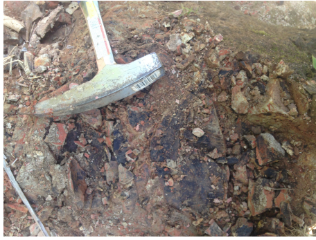
Fotografía 14 y 15. Lutitas - areniscas de grano fino con diferente grado de meteorización. Coordenadas N 481156 m y E 187205 m, Costa Rica Lambert Norte.
