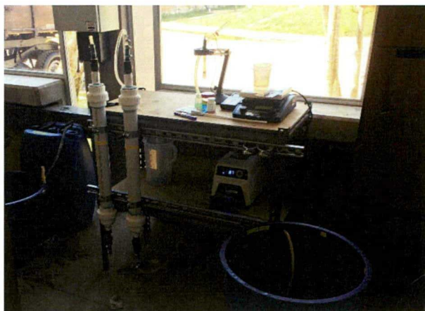
Figura 2 Operación del ensayo en columna para la regeneración de medio adsorbente
