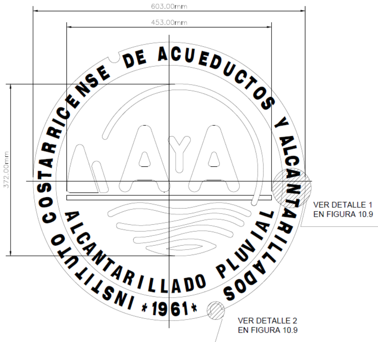
TAPA PARA POZO DE REGISTRO PLUVIAL ESCALA 1:5000
