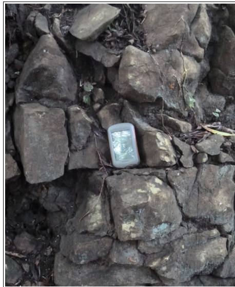
Fotografía 16. Bloques fracturados de areniscas medias calcáreas cerca de una quebrada afluente de la Quebrada Bajo Negro, alrededores de pozos P-5 y P-6. (Coordenadas: 212 201 N y 431 491 E).
