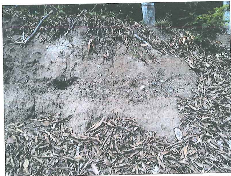
Fotografía 7: Aluviales en talud de camino entre la localidad Mangos – Garita Viejo, coordenadas 260942 N y 340699 E.
